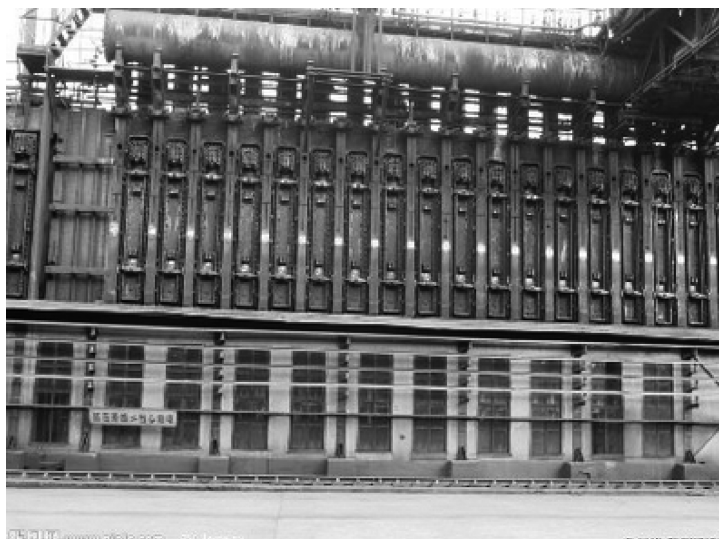
图1-2 炼焦炉及其附属设备
